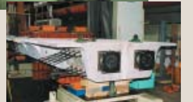
実物大載荷試験(端部)
